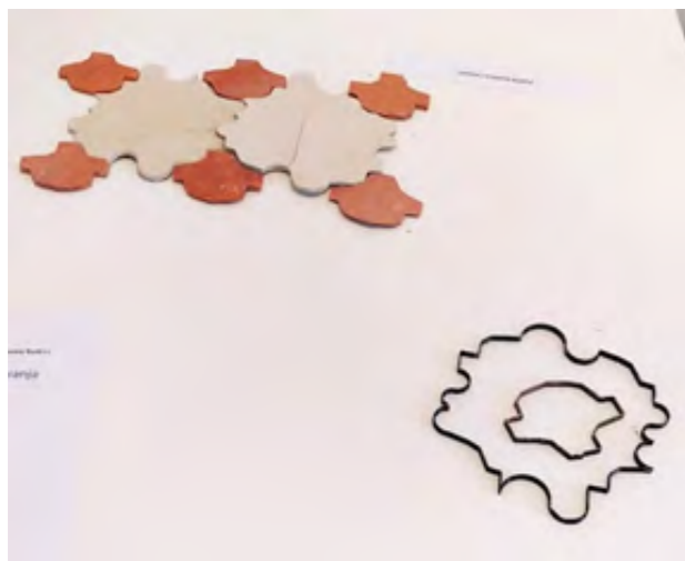
Slika 1. Unikatne escherovske pločice izrađene od glinamola i kalup ispisani na 3d pisaču
